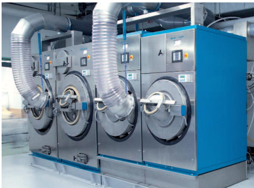
Les quatre tout nouveaux lave-linge Seibt+Kapp Variofex installés par la maison Schulthess Maschinen AG, de diverses capacités, sont raccordés à des systèmes de chargement par aspiration et traction fermés innovateurs qui garantissent une hygiène de pointe.
